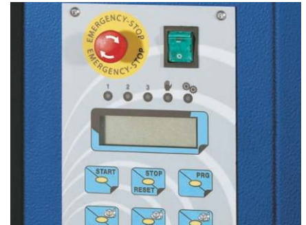
Panel sterowania z pięciocyfrowym wyświetlaczem oraz wyłącznikiem bezpieczeństwa
